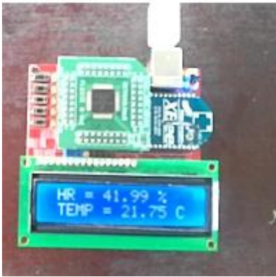
Fig. 7. Resultados de las pruebas en las plantas 1 y 2 en la LCD.
