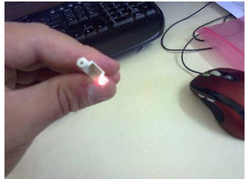
Fig. 6.- Haz luminoso en el extremo de un cable POF
