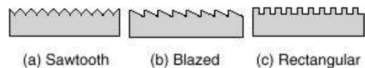
Fig. 1 Vista de corte transversal de tres redes de difracción con superficies diferentes.
