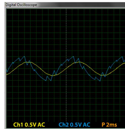
Fig.2: Captura del osciloscopio de la simulación, usando doble filtro RC y un solo filtro RC.
